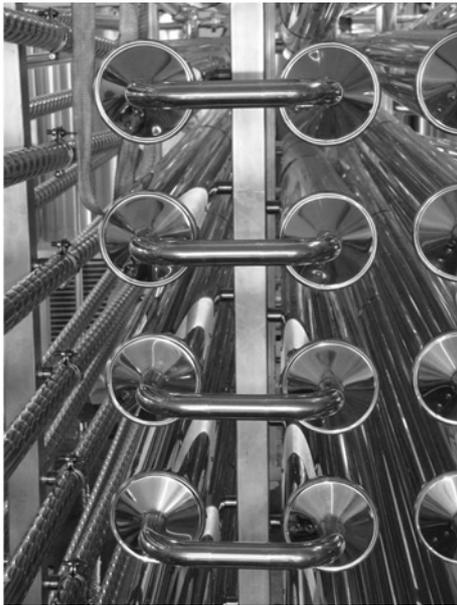
Échangeur thermique tubulaire ViscoLine installés en série avec l'isolation.
